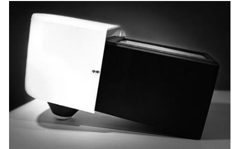
Ierīce ādas spektrālo attēlu iegūšanai vienlaicīgi pie četriem viļņu garumiem, 2020
